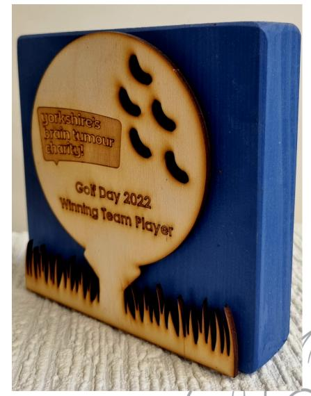
A LASER CUT AND ENGRAVED LAYER OF BIRCH PLYWOOD MOUNTED UPON A BLOCK OF RUSTIC PINE WHICH HAS BEEN PAINTED.
